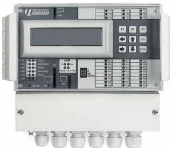
Рис. 4. Процессорный модуль УСО-КО
